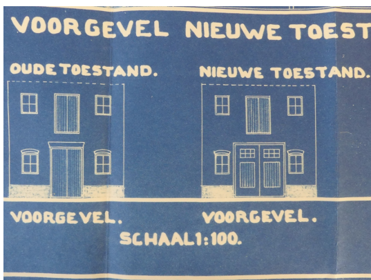
In 1930 zijn de openslaande deuren verbreed waardoor de huidige breedte van de etalage is ontstaan. [NL-ZuRAZ_145_3493]
